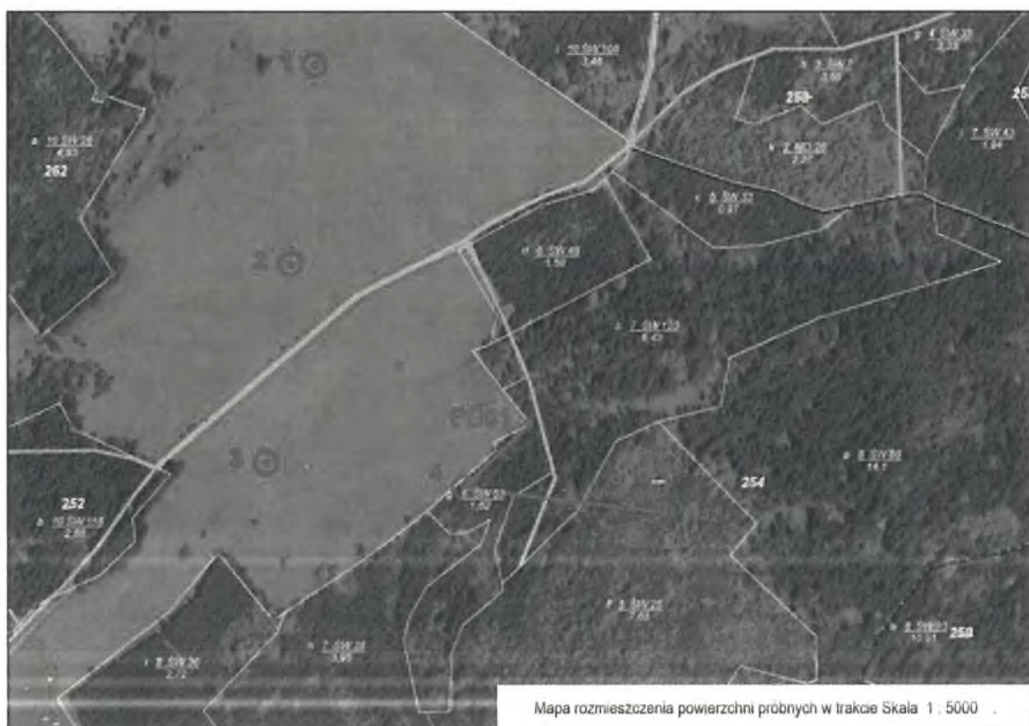
Rys. 8 Domiar do powierzchni próbnej nr 4 z punktu załamania granic (PD01). Pozioma odległość domiaru pomiędzy punktem pomiarowym a powierzchnią nr 4 – 70 m; Azymut topograficzny 210°.
